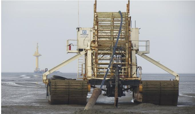
*Mit diesem Kabelleger wird das Kabel bis zum Radarturm verlegt.*
